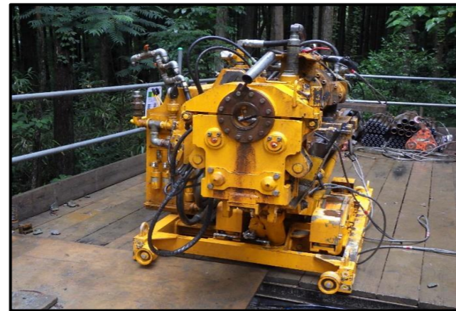
ボーリングマシン
