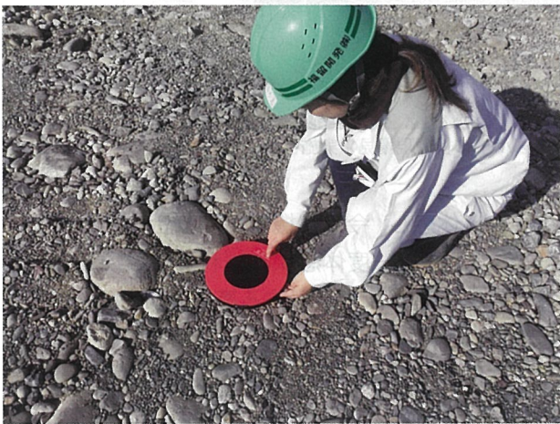
図-13 自動検出機能を有した対空標識の導入
