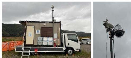
写真-5 現場休憩所に設置したIPカメラと気象観測計
