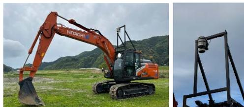
写真-6 ICTバックホウに装備したIPカメラ
