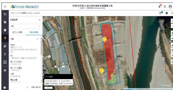
写真-1 1 施工履歴データを用いて切盛土量や進捗状況を表示した画面
