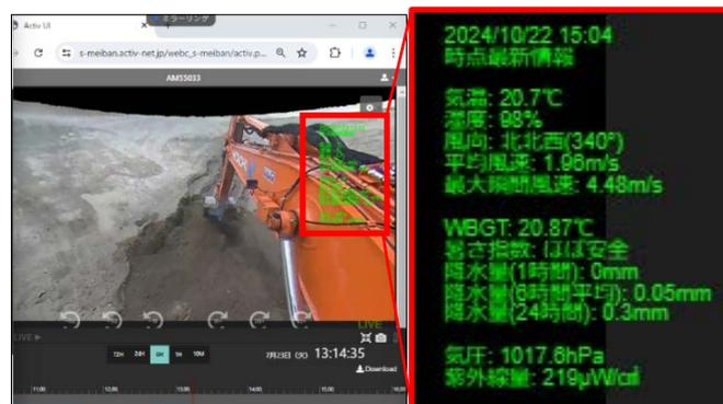
写真-8 IPカメラ（バックホウ装備）の映像と気象観測計の計測値
