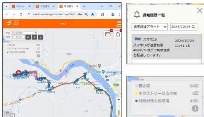
写真-10 走行位置・運搬回数を常時表示 速度違反は“速度超過アラート”として通知される
