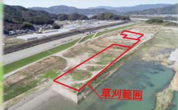
工事着手前の現場の状況です。まずは掘削を始める前に草刈をし、産業廃棄物として処分していきます。その後10tダンプトラックが通るための工事用道路を整備していきます。
