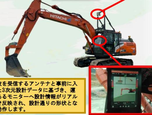
衛星電波を受信するアンテナと事前に入力された3次元設計データに基づき、運転席にあるモニターへ設計情報がリアルタイムで反映され、設計通りの形状となるよう動作します。
