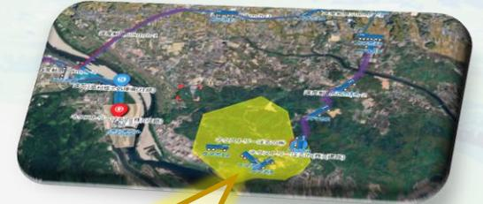
土を運搬するダンプトラックの運転手一人一人が専用のスマートフォンを持つことでダンプの運行経路や位置情報・累計運搬回数を管理者が把握できます。アナウンス機能により、速度超過通知や事故が起きやすいエリアでの注意喚起が行え、事故を未然に防ぐこともできます。
