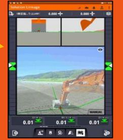
※3次元設計データとは、2次元図面を3次元化したものです。図面を3次元化することで複雑な形状や構造も直観的に把握することができます。本工事では3次元設計データを重機に転送し設計図面どおりに重機のバケット刃先位置をコントロールすることで、より正確な施工を行っています。
